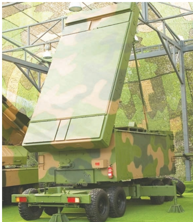
Слика 4 – Пасаивни радар са електронским скенирањем (PESA) H-200 кинеске производње
